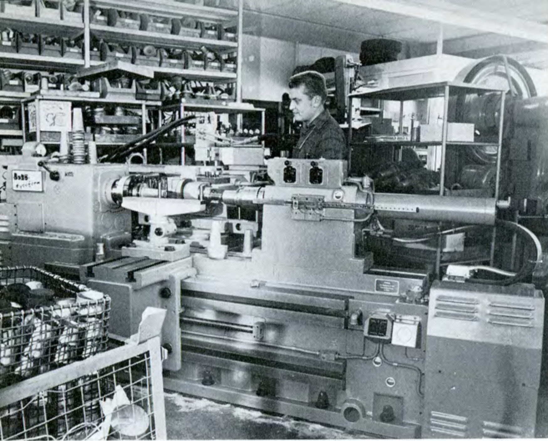
Modernste Technische Anlage Hydraulik Drückbank Platine bis 620 \phi Stärke 3,2 mm Spitzenweite 900 mm
